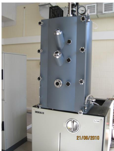
Рис. 1. Установка синтеза оксидных кристаллов методом Чохральского «Ника-3».
